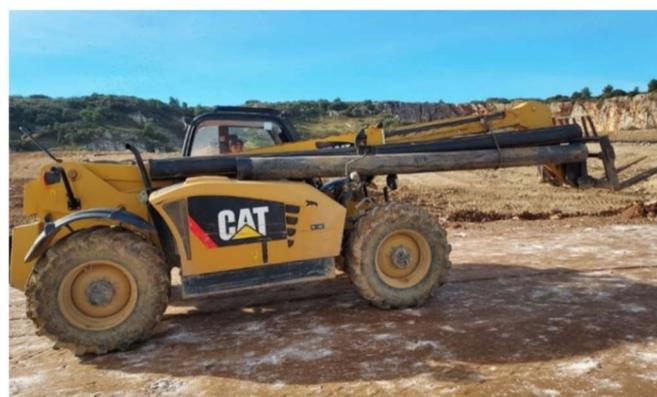
Le chariot télescopique TH 407 Caterpillar nous permet le déplacement des conteneurs de produits chimiques.
